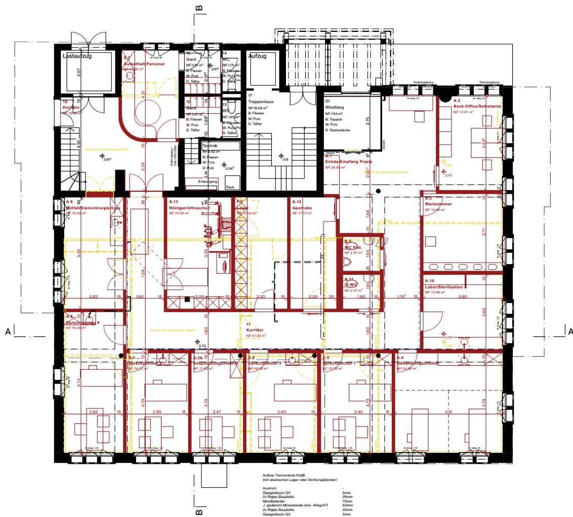
Detailplan Erdgeschoss mit Hauptnutzungsfläche 243 m<sup>2</sup>, Verkehrsfläche (Korridor) 76,78 m<sup>2</sup>, Nebennutzfläche 22,83 m<sup>2</sup>, Totalfläche 343 m<sup>2</sup> mit Option Nutzung Lagerraum im UG.
